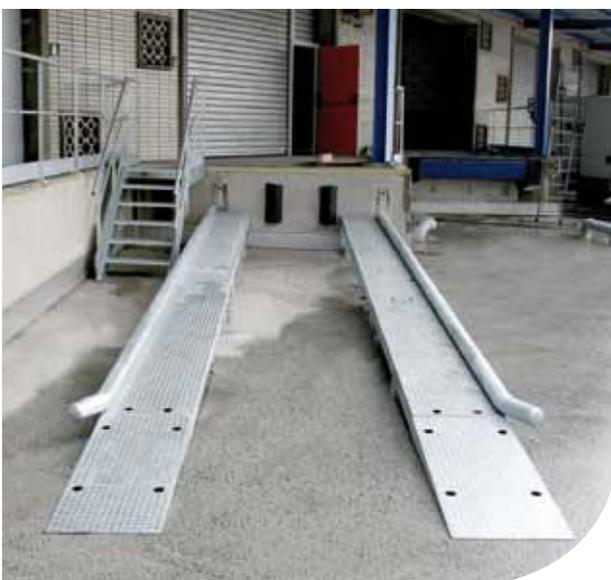
Pratiques et simples d'utilisation, les rehausses pour petits camions et camionnettes permettent à ceux-ci de mieux se positionner par rapport au quai, ce qui facilite et sécurise le transbordement des marchandises via les engins de manutention.
